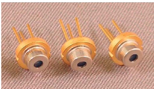
FIG 15-9 Fotodiodos. Cortesía de LaserMate Group, Pomona, CA.
